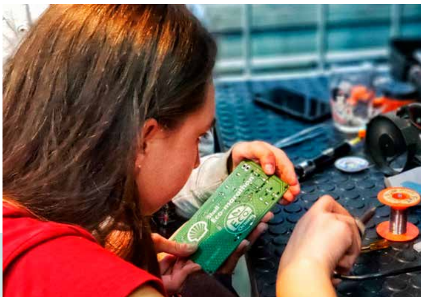
Figura 1: Soldagem da placa de distribuição de energia do veículo
